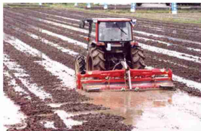
水田ハローによる浅水代かきの作業
